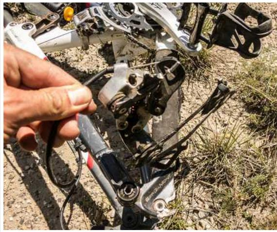
Am alten Scott hatte sie das Schaltwerk zwar auch schon einmal abgerissen, aber das zählt nicht. Da bei diesem Rad das Schaltwerk direkt in den Rahmen geschraubt wurde, war gleich die gesamte Hinterbauschwinge für knapp zweihundert Euro im Eimer gewesen.
